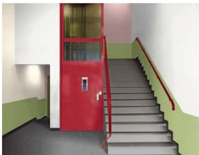
**Barrierefreie Kontraste ermöglichen die differenzierte Wahrnehmung der Umgebung. Der Fahrstuhl sowie Boden, Treppe und Handlauf setzen sich deutlich von der Wand ab, sodass Menschen mit Sehschwächen sich besser zurechtfinden können.**
